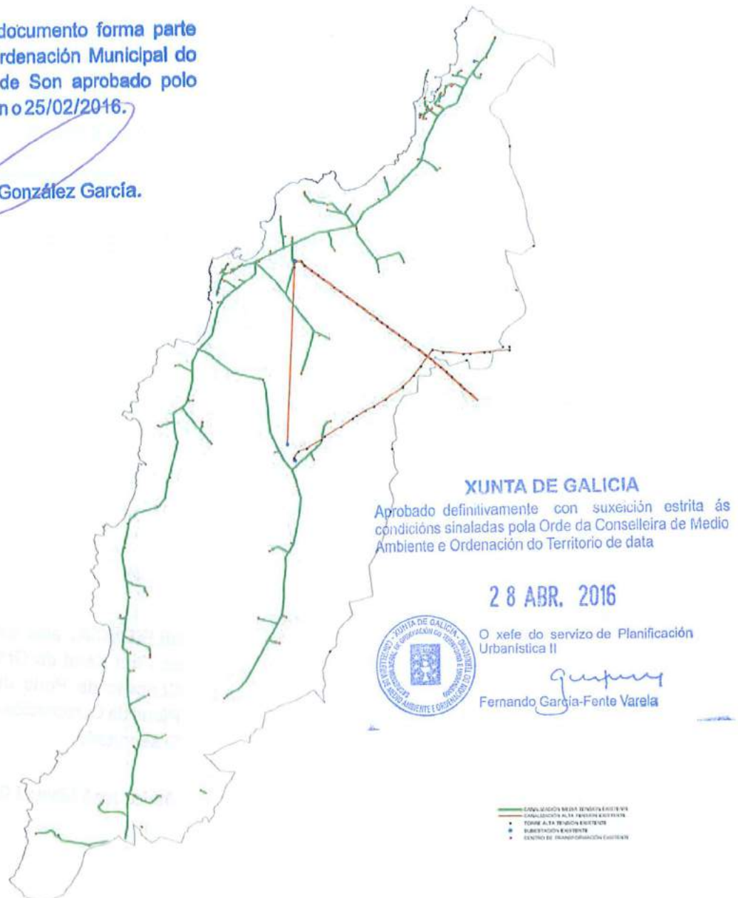
Plano da rede de subministración en alta e media tensión de Porto do Son.
